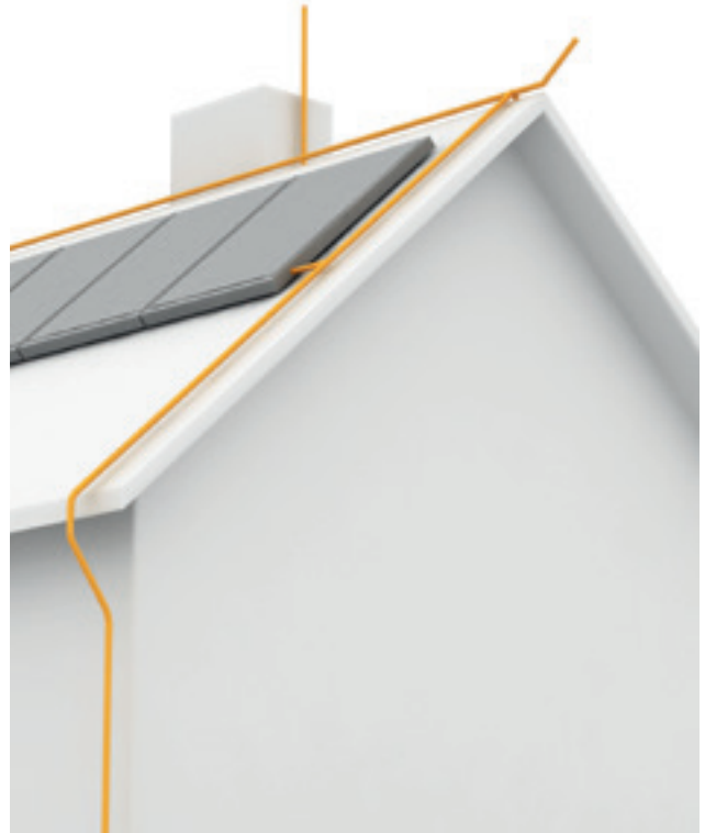
Aurinkosähkölaitteiston asennustelineen suora liitäntä salamasuojajärjestelmään on vältettävä.
