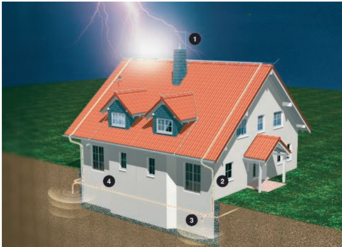
1 = sieppausjärjestelmä 2 = alastulojohtimet 3 = maadoitusjärjestelmä 4 = potentiaalintasaus
