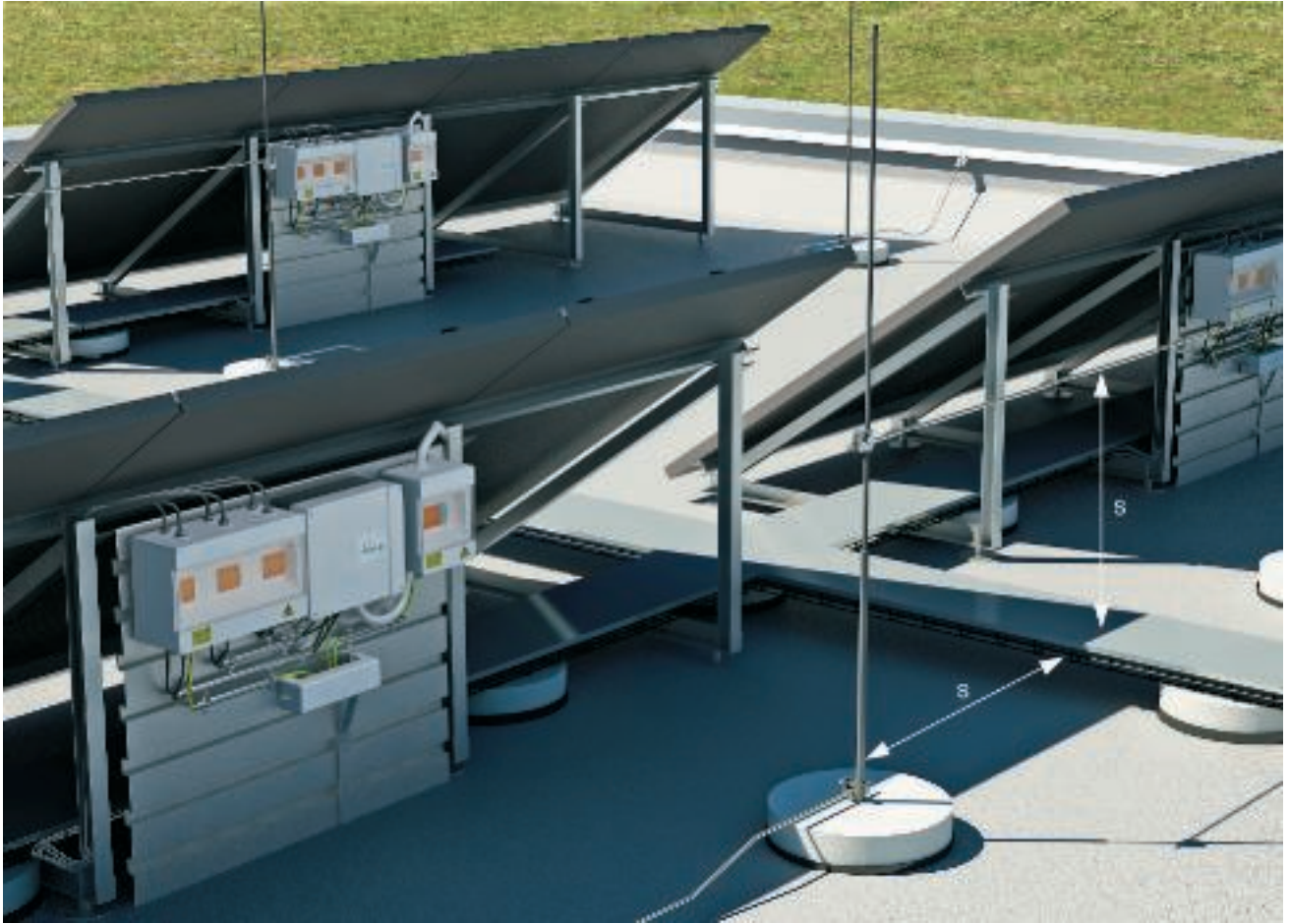
Kuva 5: Erotusväli (s) johtokanavan ja sieppaustangon välissä
